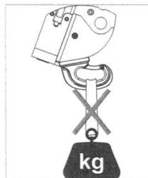
Abb. 3-22 Falsche Verwendung des Lasthakens
